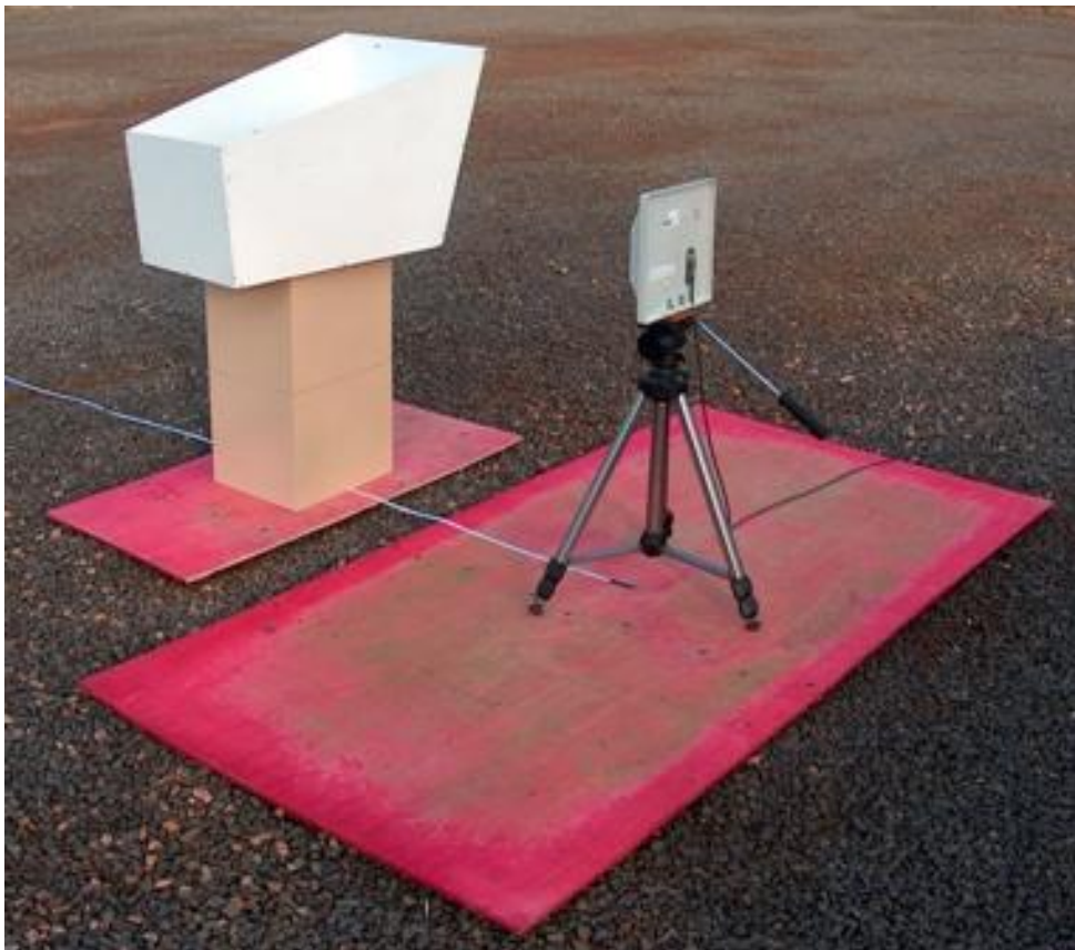
Figura 4 – Posicionamento da Etiqueta RFID (TAG) no suporte dentro do recipiente (a esquerda) e posição da antena do Leitor RFID (a direita) utilizado para os ensaios
