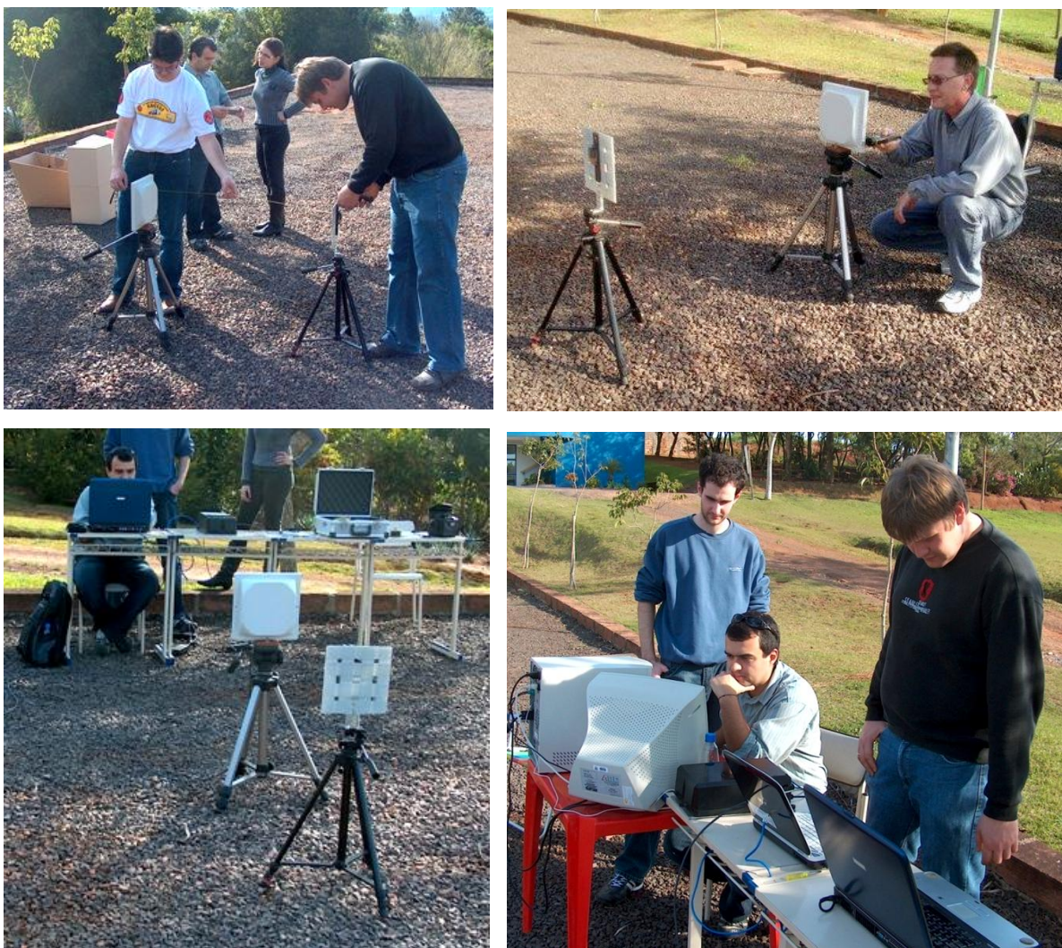
Figura 3 – Sequência dos ensaios realizados em “espaço livre” com o primeiro suporte desenvolvido com a Etiqueta RFID fixada e a Antena do Leitor RFID
