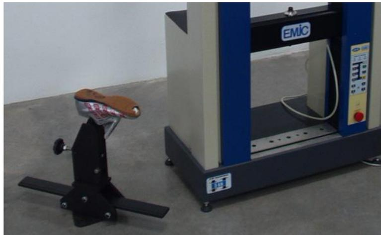
Figura 2 - Dispositivo para ensaios de descolamento de solado pela norma DIN 4843 e método SATRA.
