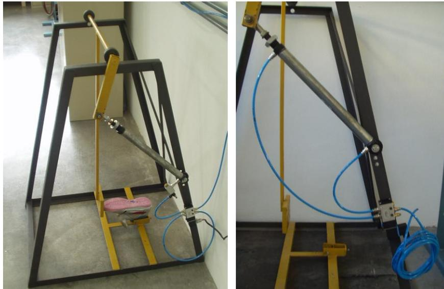
Figura 8 – Automação eletropneumática do protótipo.
