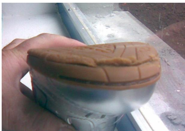
Figura 7 – Rasgamento do solado ao impacto no protótipo.
