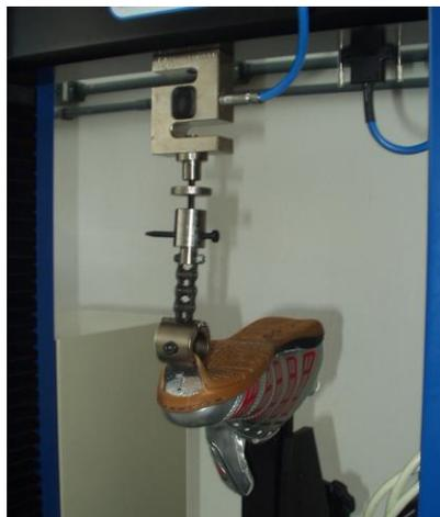
Figura 9 – Ensaios realizados com a máquina convencional.
