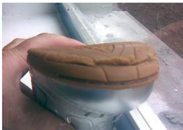
Figura 9 – Rompimento do solado ao impacto no protótipo.
