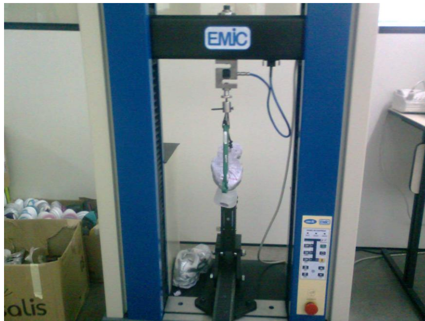
Figura 2 – Calçado Esportivo sendo testado em ensaio de deslocamento de solado pela norma DIN 4843 e método SATRA.
