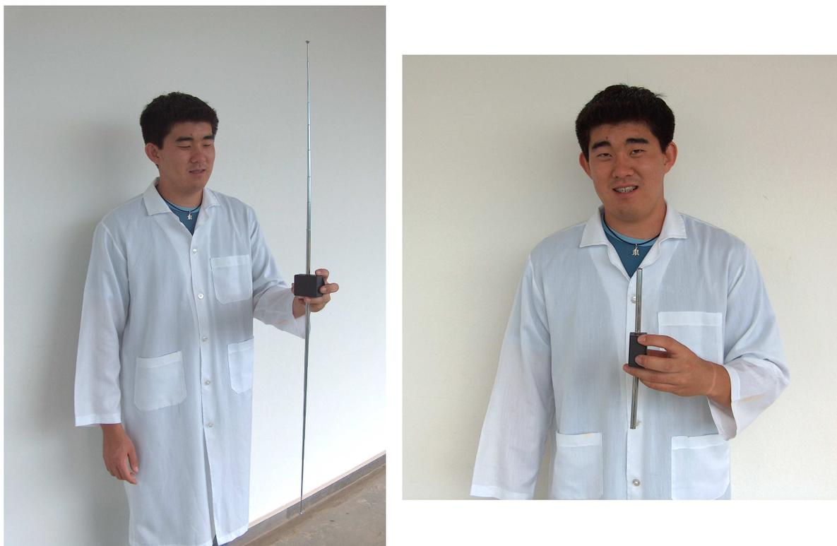
Figura 2 – Antena dipolo ajustável desenvolvido, na polarização vertical, em relação ao corpo humano
