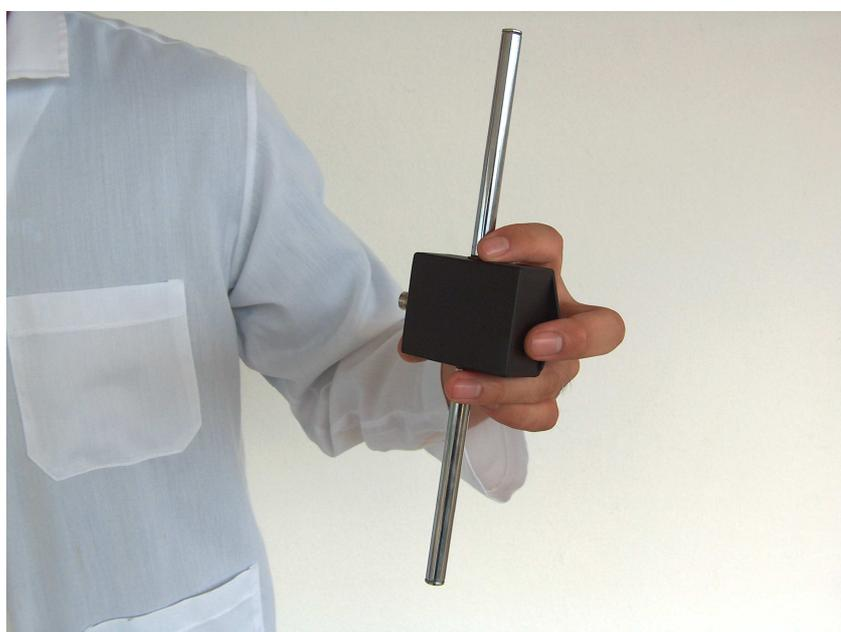
Figura 1 – Antena dipolo ajustável
