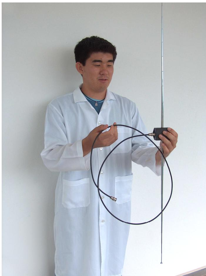
Figura 3 – Antena dipolo ajustável com cabo coaxial conectado
