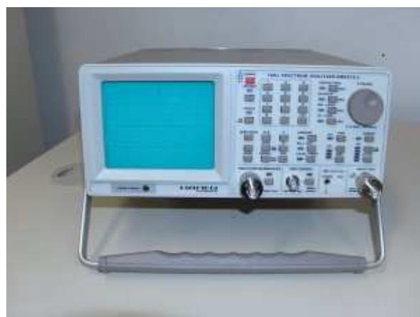
Figura 5 – Analisador de Espectro adquirido para os experimentos da pesquisa
