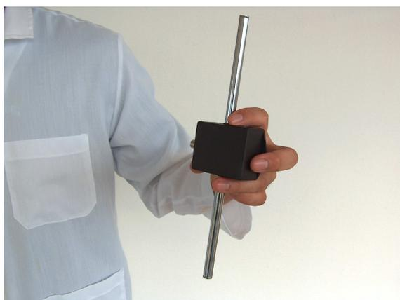
Figura 3 – Antena dipolo ajustável
