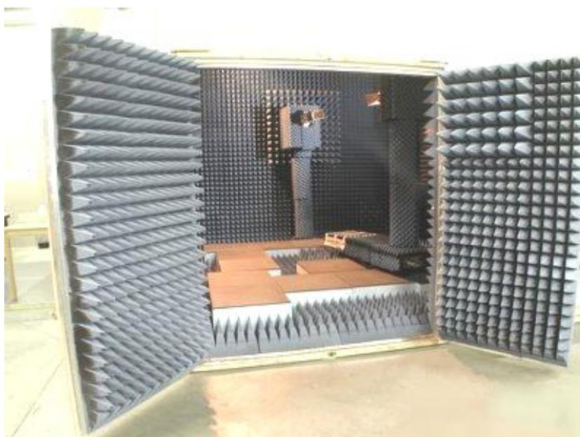
Figura 1 – Câmara Anecóica para ensaios que utilizam sinais de radiofrequências (RF)<sup>4</sup>
