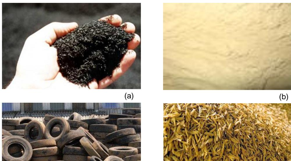
Figura 6 – Pó de borracha de pneus (a) e pó obtido a partir de cascas de arroz (b)
