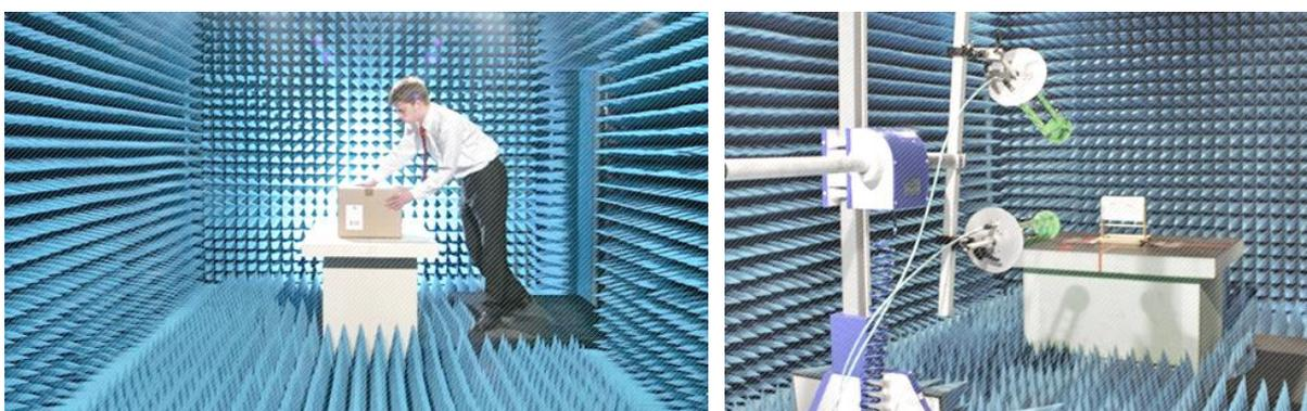
Figura 10 – Câmara anecóica para ensaios de embalagens para análise da influência de diversos tipos de materiais em relação a eficiência da leitura de Etiquetas (TAG) RFID quando fixadas na parte externa da embalagem e internamente nos produtos acondicionados.
