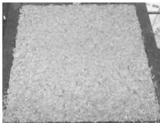
Figura 23 – Absorvedor elaborado a partir de cascas de arroz em forma de placa plana
