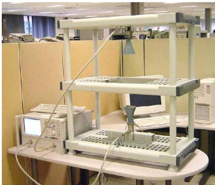
Figura 32 – Estrutura para *Free-Space X-Band System* (8,2 to 12,4 GHz) – Agilent Technologies<sup>72</sup>
