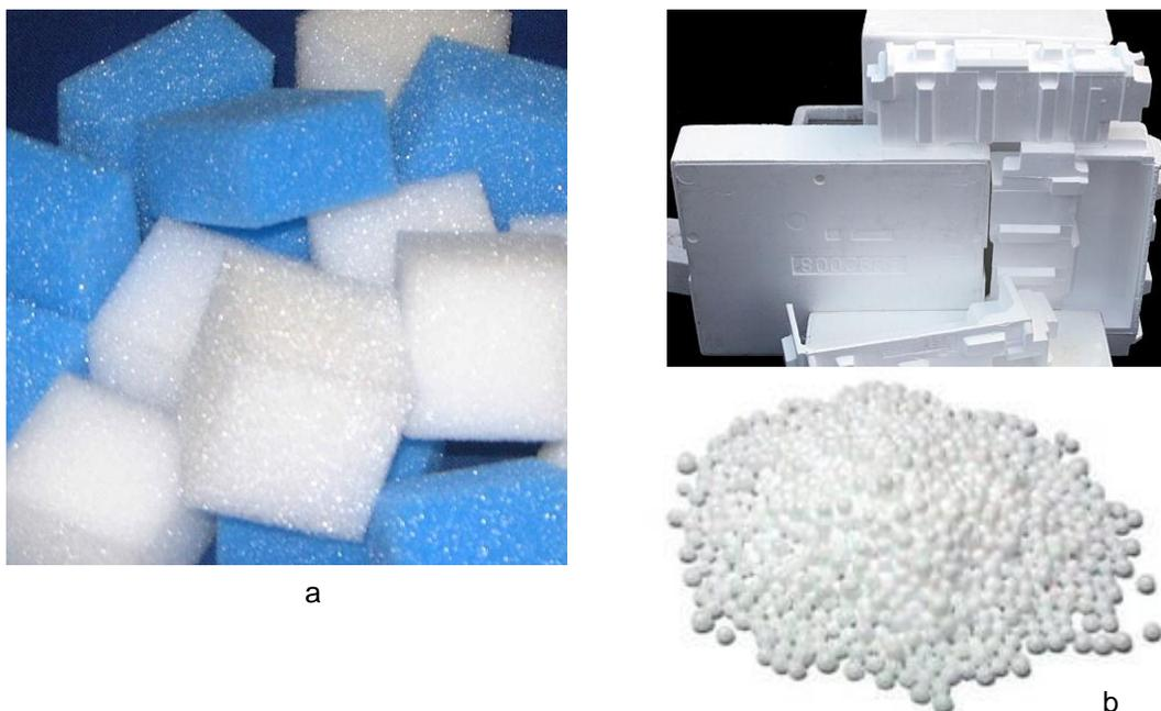
Figura 3 – Espuma produzida com poliuretano (a) e Isopor produzido com poliestireno expandido (b)
