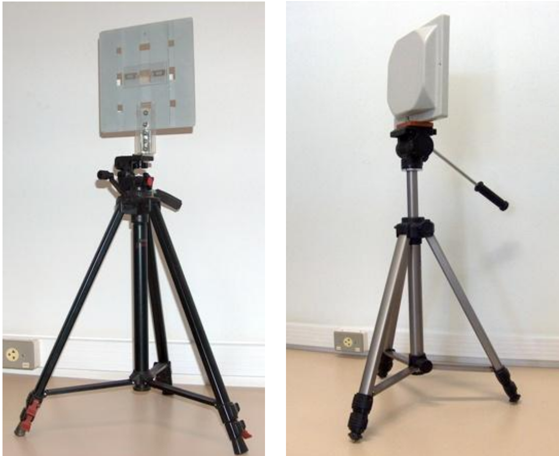
Sistema Experimental Construído (p/ Etiqueta RFID) Sistema (Antena) Comercial Existente (p/ o Leitor RFID)
