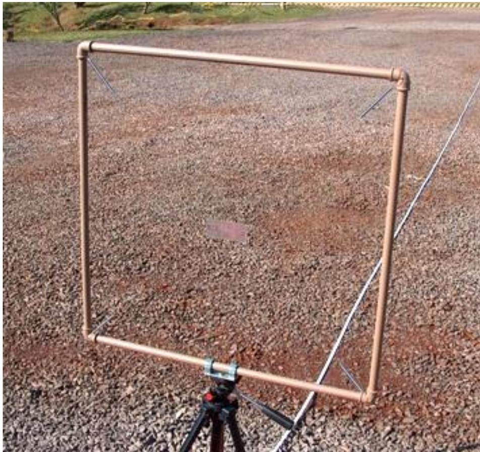
**Figura 3 – Suporte construído para fixação da Etiqueta RFID para ensaios em “espaço livre”**
