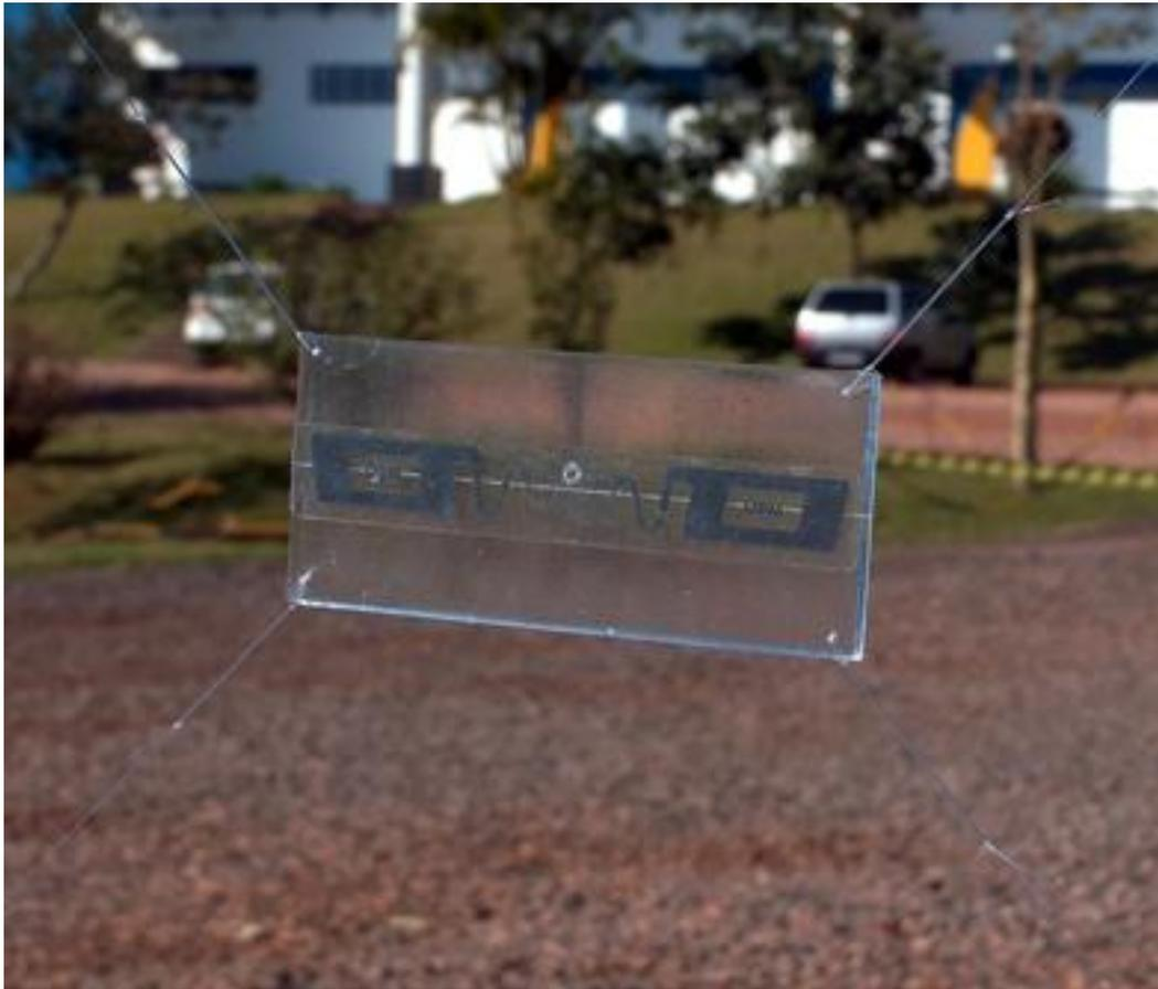
**Figura 4 – Sistema para fixação e suspensão da Etiqueta RFID no suporte para ensaios**
