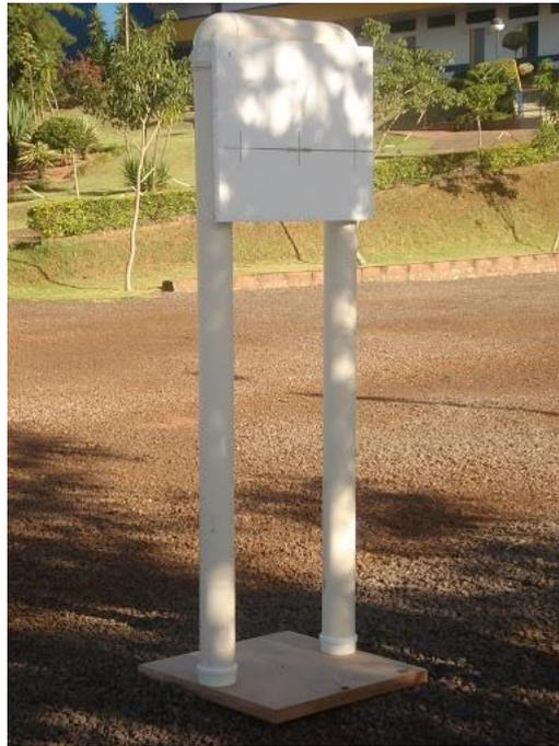
**Figura 1 – Suporte projetado para fixação das chapas de diferentes materiais com uma chapa construída com isopor**
