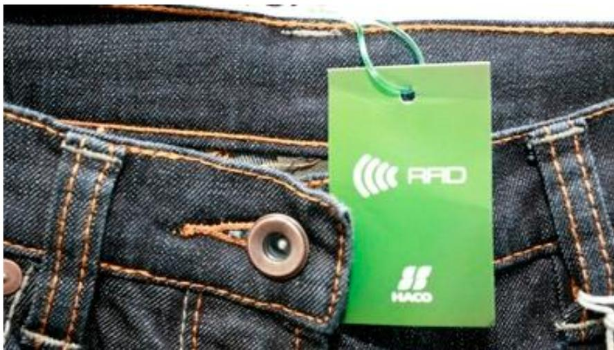
**Figura 1 – Etiqueta RFID (TAG) colocada próxima de um produto (calça Jeans)**
