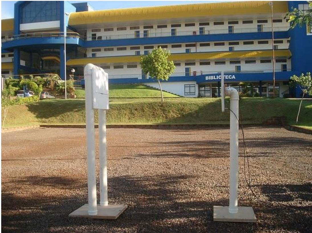
**Figura 5 – Aspecto da configuração do sistema de transmissão e recepção para os ensaios com diferentes tipos de chapas de materiais**
