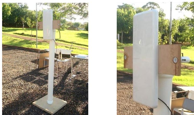
**Figura 4 – Aspecto da configuração do suporte com a Antena do Leitor RFID instalada**
