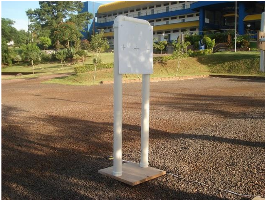
Figura 2 – Suporte com a chapa de isopor instalada e com a Etiqueta RFID fixada ao centro com polarização horizontal.
