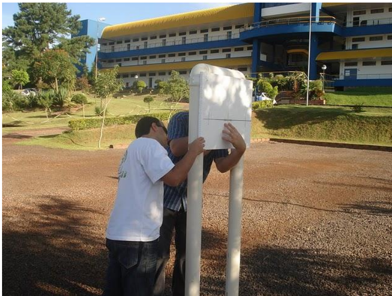
Figura 1 – Instalação da chapa de isopor com a Etiqueta RFID (TAG) colocada ao centro
