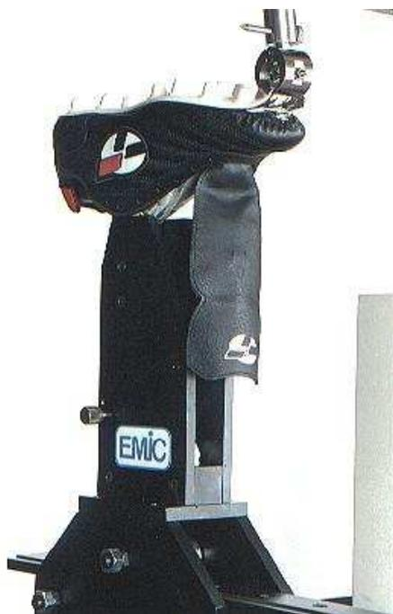
Figura 1 – Sistema atual para ensaio da resistência de adesão do solado ao cabedal
