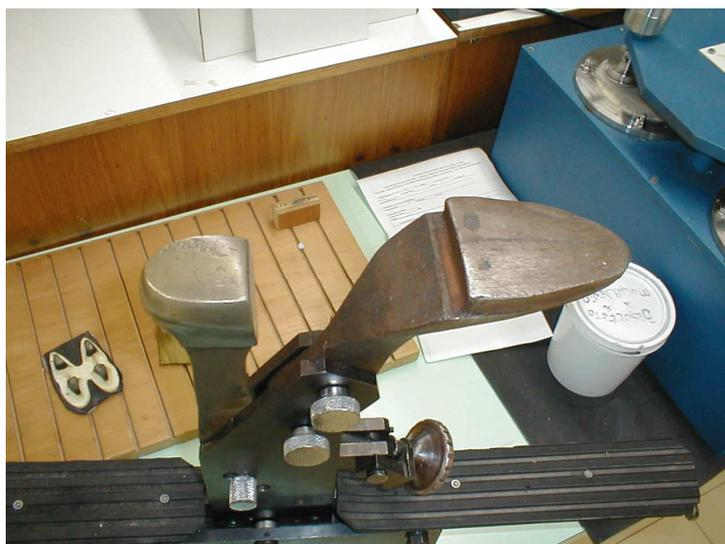
Figura 2 – Pé de Moleque, dispositivo utilizado para a fixação do calçado
