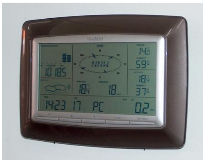
Figura 4 – Central de controle da Estação Meteorológica 01 (em funcionamento)
