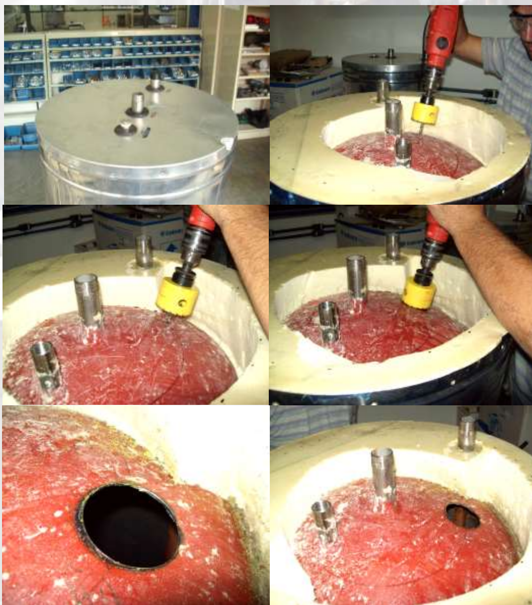
Figura 20 – Alteração no Boiler para instalação da serpentina condensadora.
