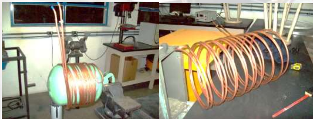
Figura 21 – Dobra do tubo de cobre para construção do condensador em forma helicoidal.
